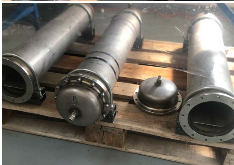
Plnění autoklávu v ÚTAM, vzorky oceli L80-1 od MND ES
