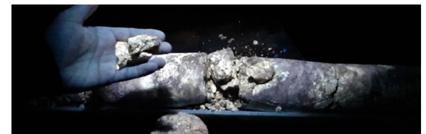
Vrtné jádro z vrtu Čeložnice 1 pod UV lampou – bílé emitované světlo (luminiscence) indikuje přítomnost ropy.
